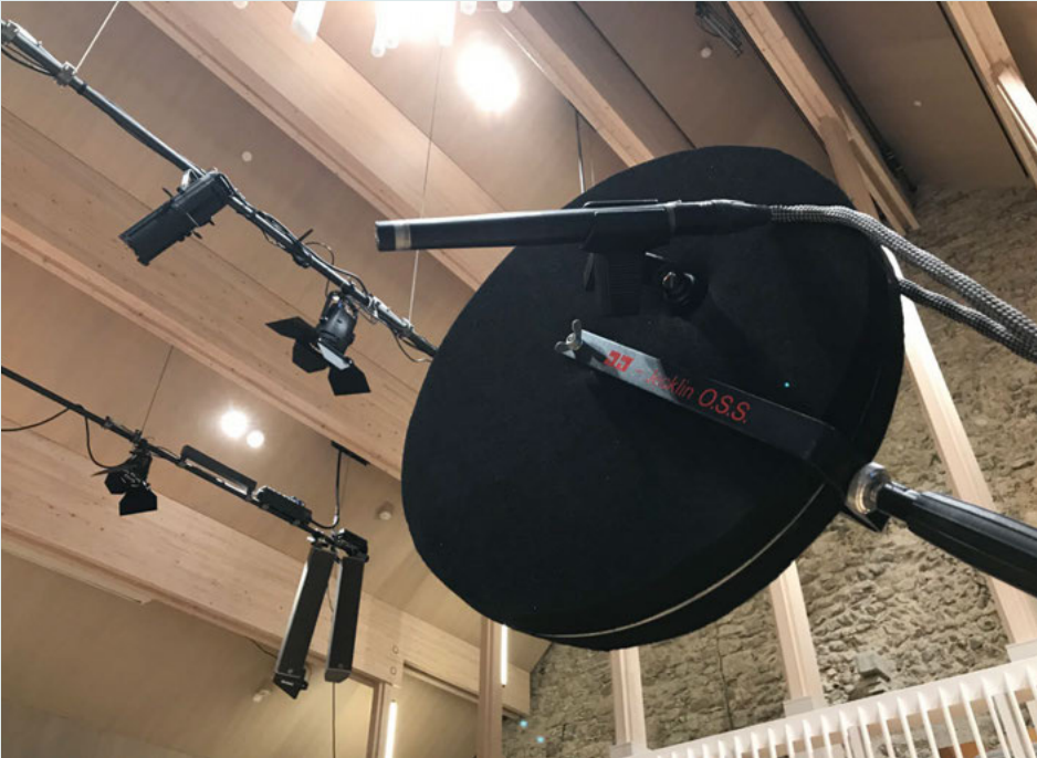
OSS-Anordnung: 2 Kugelmikrofone mit Abstand von 36cm und Öffnungswinkel von 60°, mit Schaumstoff belegte Scheibe von 35cm Durchmesser
